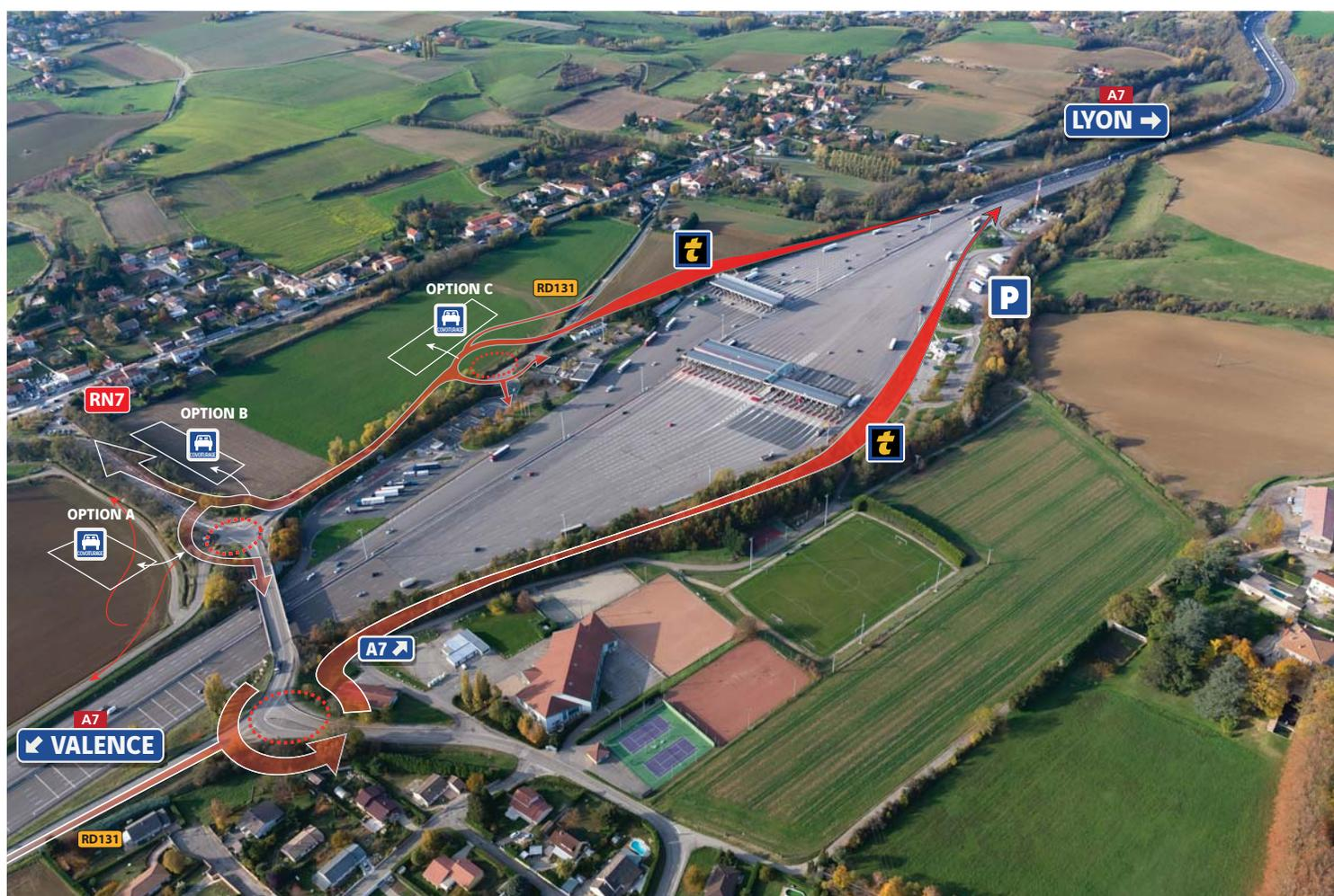
La sous-variante centre compacte est une déclinaison de la variante centre qui consiste à rapprocher au maximum le demi-échangeur de la barrière de péage en pleine voie, dans l'objectif principal de limiter l'impact du projet sur les terrains de sports et le chemin communal de Reventin-Vaugris.
